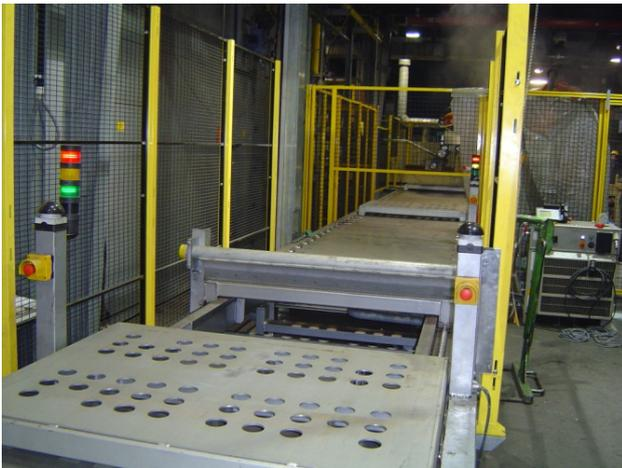
**Bild 3:** Anlage im Probetrieb mit teilweise errichtetem Schutzzaun; Not-Aus-Kreise und optische Warn-einrichtungen sind bereits funktionsbereit
