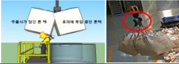
< 재해발생 前 톤백 줄걸이 상태 >
