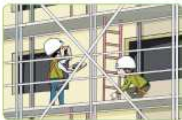
추락위험장소에 작업발판 안전난간 설치
