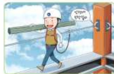
안전대 착용 및 부착설비 설치
