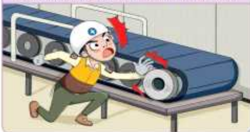
① 가동 중인 컨베이어 롤러 이물질 제거 중 끼임
