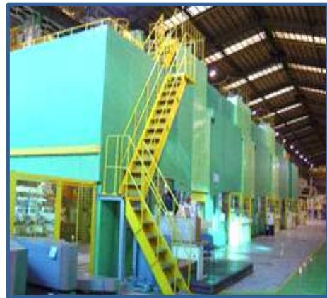
② 대형설비 상부 점검통로 안전난간 설치
