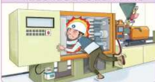
③ 사출성형기 금형 설치 중 금형 사이에 끼임
