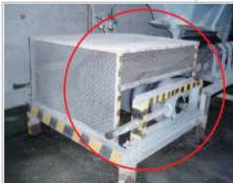
테일폴리* 방호울 설치 (컨베이어 끝단을 지지하는 폴리)
