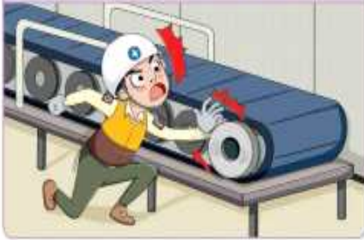
① 가동 중인 컨베이어 롤러 이물질 제거 중 끼임
