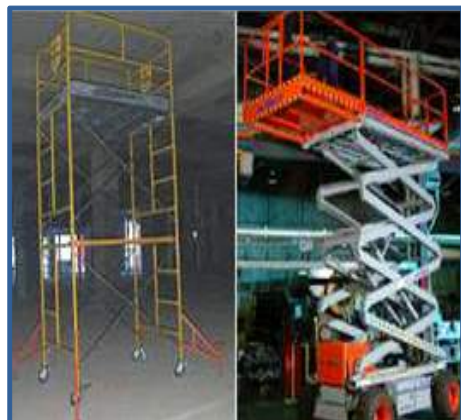
④ 떨어짐 위험지역 안전 작업발판 설치 또는 고소작업대 사용
