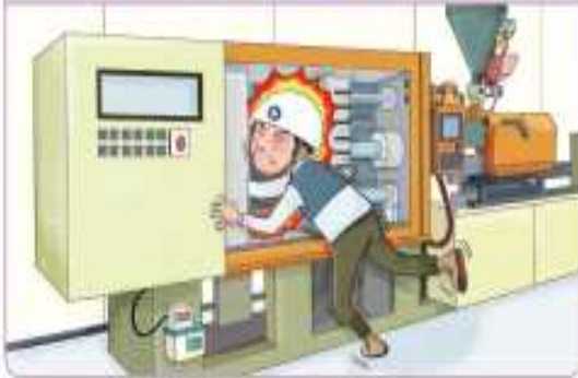
③ 사출성형기 금형 설치 중 금형 사이에 끼임
