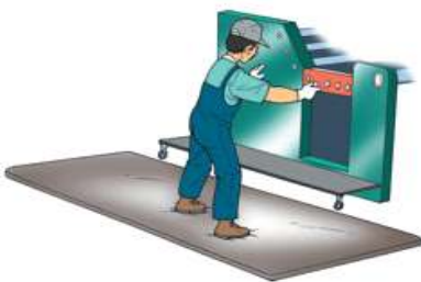
⑥ 피로예방 매트를 작업자 바닥에 설치
